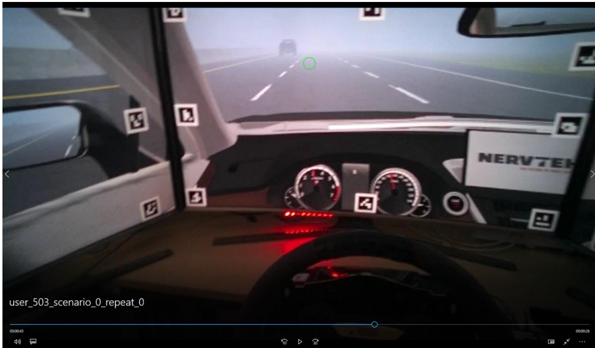
Slika 3: Prevzem vožnje z vidika udeleženca - avtonomno vozilo je zaznalo oviro na levi strani in to vozniku sporočilo preko taktilnega vmesnika na sedežu in levega dela LED traku. Posnetek je bil zajet s pomočjo očal Tobii Pro Glasses 2. Zeleni krog na vetrobranskem steklu kaže usmerjenost pogleda udeleženca v tem trenutku. Udeleženec je še v fazi ocenjevanja situacije in še ni položil rok na volan.
